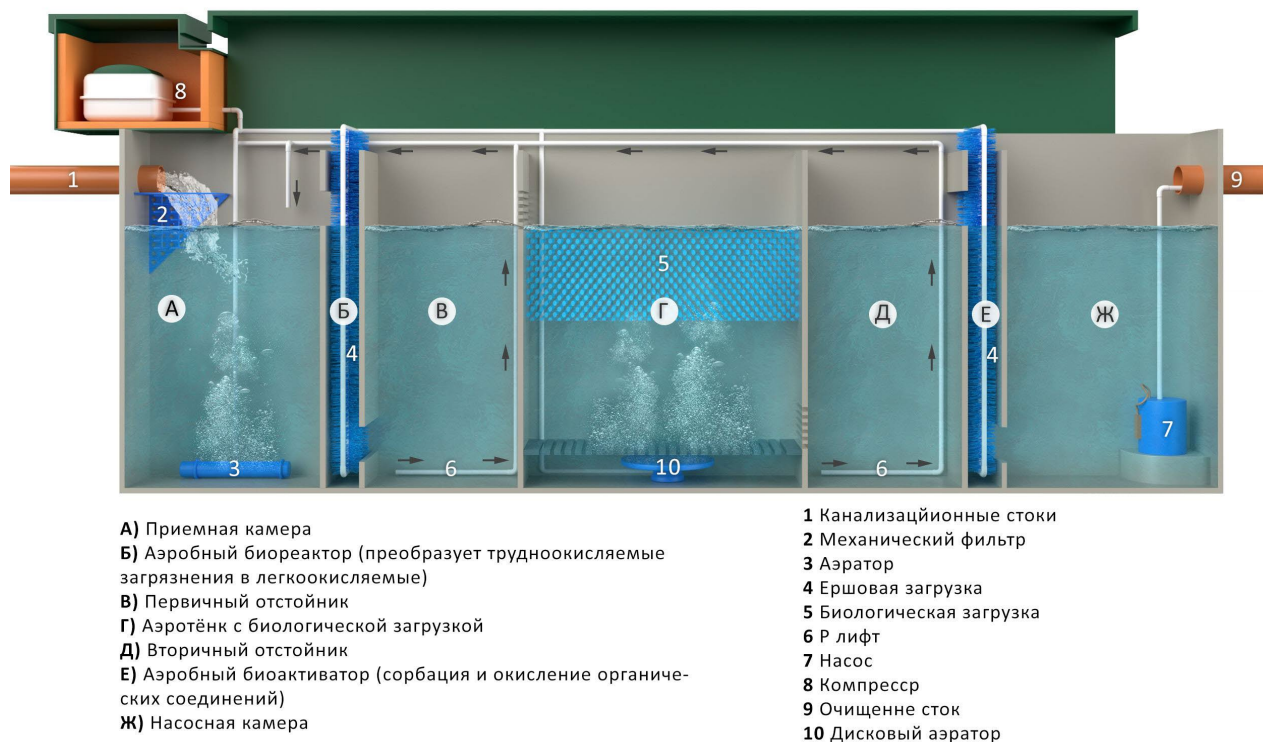
Рис. 1. Состав конструкции установки
