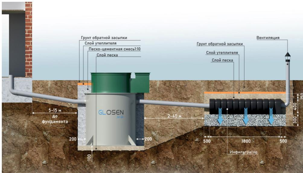
Монтажа установки GLOSEN с фильтрационным колодцем. Подходит при условии песчаной почвы и низком уровне грунтовых вод (ниже 1,5 м).
