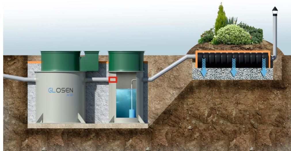
Монтажа установки GLOSEN с фильтрующей траншеей (песчано-гравийный фильтр) и сбросом на рельеф. Подходит для невпитывающих грунтов (глиня, суглинок).
