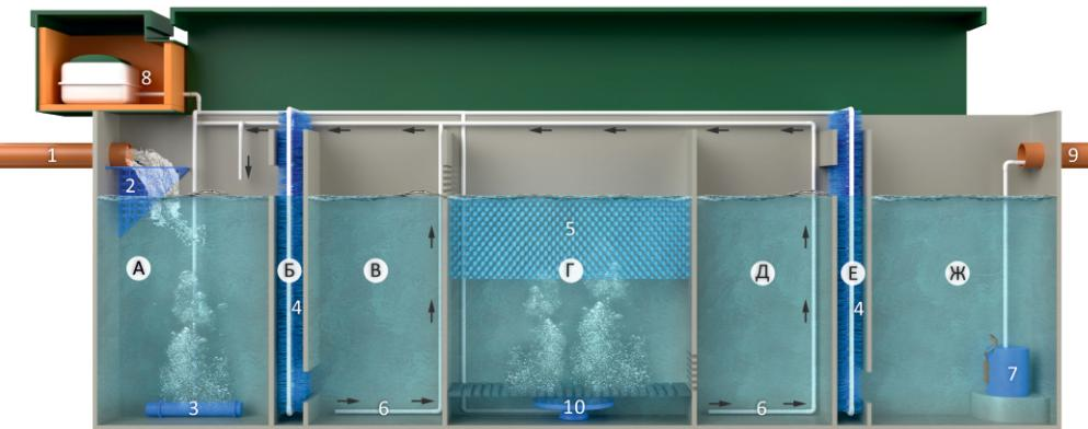
А) Приемная камера, Б) Аэробный бioreактор, В) Первичный отстойник Г) Аэротёнк с биологической загрузкой Д) Вторичный отстойник, Е) Аэробный биоактиватор, Ж) Насосная камера.
