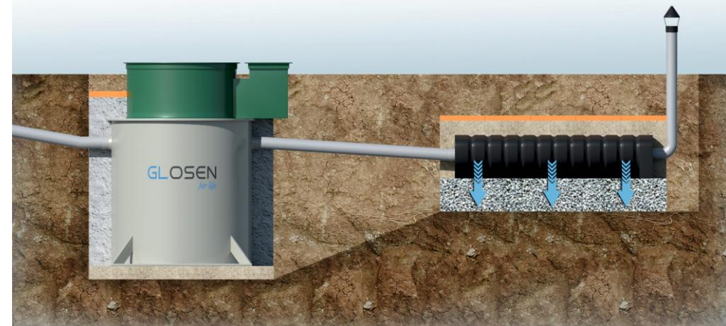
Схема монтажа установки GLOSEN с промежуточным колодцем, обратным клапаном и дренажным насосом. Подходит для монтажа с высоким уровнем грунтовых вод.
