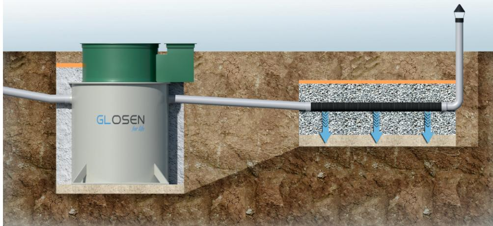
Монтажа установки GLOSEN с фильтрационным полем через дренажный тоннель. Подходит для монтажа с низким уровнем грунтовых вод (ниже 1,5 м.) и впитывающими грунтами.
