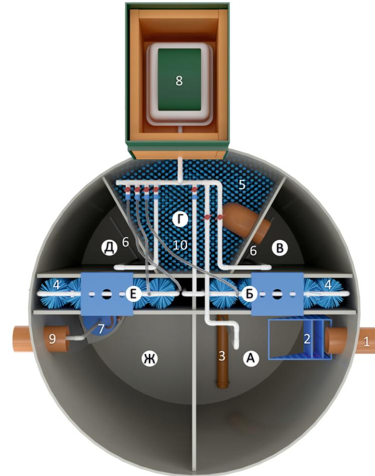
**А)** Приемная камера, **Б)** Аэробный биореактор, **В)** Первичный отстойник **Г)** Аэротёнк с биологической загрузкой **Д)** Вторичный отстойник, **Е)** Аэробный биоактиватор, **Ж)** Насосная камера.
